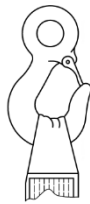
NOTE Le rayon de bousille n'est pas mentionné pour le circuit de l'illustration. Figure D.1 — Illustration montrant l'installation inadéquate d'une bousille d'lingue sur un crochet de trop petit rayon
