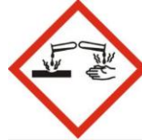
Enthält korrosiv (Batterie)
