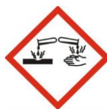
Zawiera substancje żrące (akumulator)
