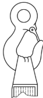
NOTE Le report de boucle n'est pas montré pour le clou de fixation. Figure D.1 — Illustration montrant l'installation inadéquate d'une boucle d'élingue sur un crochet de trop petit rayon
