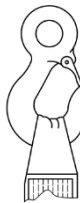
NOTE Le point de boucle n'est pas montré pour le côté de l'abaîssation. Figure D.1 – Illustration montrant l'installation inadéquate d'une boucle d'élingue sur un crochet de trop petit rayon
