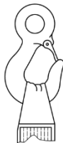
NOTE Le rayon de boudin n'est pas montré pour la clarté de l'illustration. Figure D.1 — Illustration montrant l'installation inadéquate d'une boucle d'élingue sur un crochet de trop petit rayon
