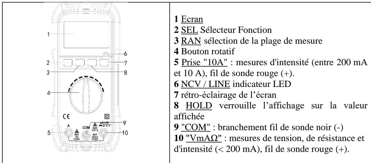
Afin de prolonger la vie de la pile, ce sélecteur doit être positionné sur "OFF" quand on n'utilise pas l'appareil.
