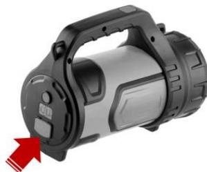
Για να επαναφορτίσετε τη λάμπα, ανοίξτε το κάλυμμα που βρίσκεται στο πίσω μέρος της λάμπας και συνδέστε τη λάμπα σε μια συσκευή φόρτισης μέσω του παρεχόμενου καλωδίου.
