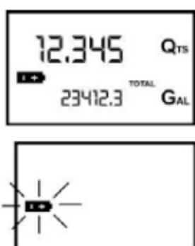
Lorsque la charge de la batterie tombe en dessous du premier niveau sur l'écran LCD, le symbole de la batterie fixe apparaît.
