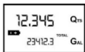
Cuando la carga de la batería cae por debajo del primer nivel en la pantalla LCD, aparece el símbolo de batería fija.
