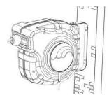
Le dévidoir doit pouvoir se fixer sur un mur et pivoter sur un arc de 180°.
