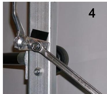
Montar el pie de soporte I, atornillarlo en la parte inferior y colocarlo a lo largo de la placa encolada. Montar la tuerca de fijación D (véanse fotos 3 y 4 y fig. 1).
