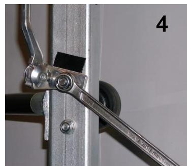
Voetsteun I wordt gemonteerd, hij wordt helemaal in het chassis gedraaid, langs de opgelijmde plaat.
