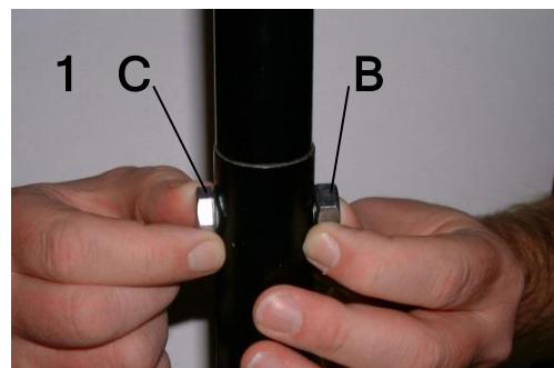
La barre de conduite est assemblée au châssis F ((cf. Photo 2 et Fig. 1). La rondelle E et le bouchon d'obturation D sont montés.
