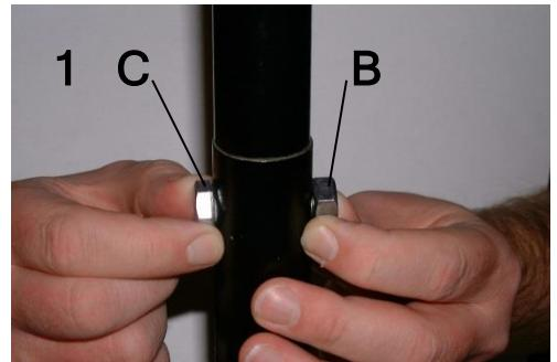
Una vez completo, unir el manillar al chasis F (véanse foto 2 y fig. 1). Montar la arandela E y la tuerca de fijación D.
