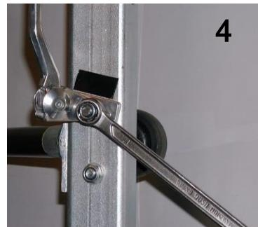
La béquille I est montée, vissée vers le bas et appliquée sur la plaque collée.
