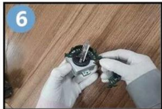
Mettre le support sur la nouvelle ampoule
