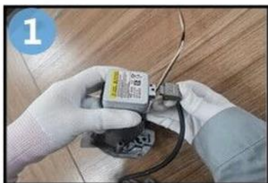
Débrancher le ballast d'origine
