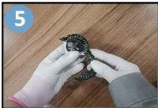
Déverrouiller le support et le séparer de l'ampoule
