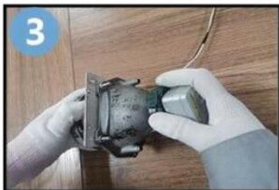
Tourner dans le sens antihoraire et retirer le support et l'ampoule
