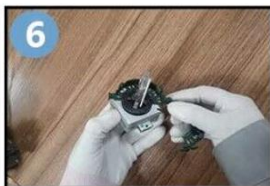
Mettre le support sur la nouvelle ampoule
