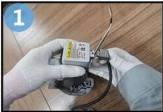
Débrancher le ballast d'origine
