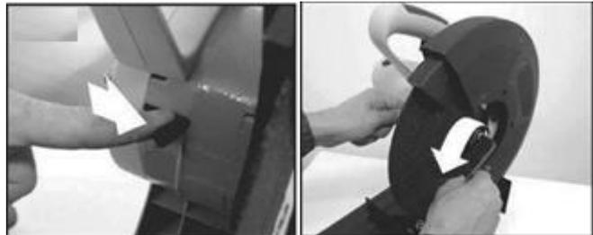
En tenant l'axe, enclencher la manette de blocage de l'arbre et tourner, avec la clé fournie, le boulon de retrait du disque (sens antihoraire).
