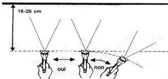
Pression air comprimé : 2.0 à 3.0 bars
