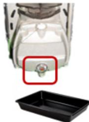
4. Dévisser le bouchon fileté de vidange, situé sous le regard de niveau d'huile. Si l'huile ne s'écoule pas complètement, pencher légèrement le compresseur
