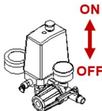
6. Après utilisation, libérer l'air comprimé. Pour évacuer la surpression contenue dans le compresseur, éteindre le compresseur et utiliser l'air comprimé restant dans le récipient de pression. Par exemple, au moyen d'un pistolet de soufflage ou d'un outil à air comprimé qui tourne à vide.
