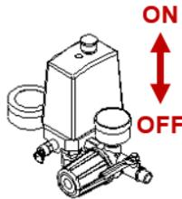
4. Le compresseur est contrôlé automatiquement par un pressostat. Celui-ci s'arrête automatiquement lorsque la pression atteint la valeur maximale et redémarre automatiquement lorsque la pression revient à la valeur minimale.
