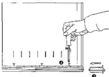
Insérer le nouveau bloc verrouillage, dans le bon sens, puis serrer les vis
