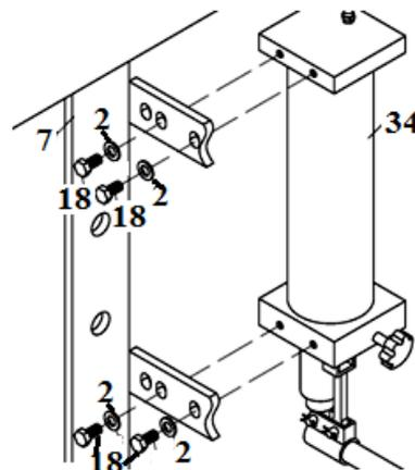
Déplacer l'ensemble de pompe (34) à l'extérieur du poteau, utiliser le boulon (18) et la rondelle (2) pour la fixer sur le bon plat.
