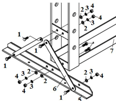
Attacher la section basse (05) et le plat (06) à l'aide du boulon (01), de la rondelle (02), de la rondelle de freinage (03) et de l'écrou (04).
