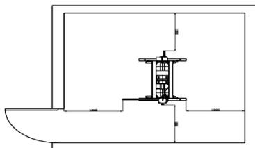
Un espace de travail de 1m doit être maintenu libre devant et derrière la machine lors qu'il du fonctionnement de sorte qu'elle soit toujours facilement accessible.
