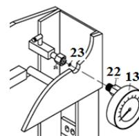
Assembler la rondelle nylon (23) à sur le capteur de pression (22), puis mettre l'indicateur de pression (13) et serrer fortement. Remarque : serrer aussi fortement que possible, afin d'éviter toute fuite
