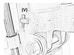
(V) valvola di scarico
