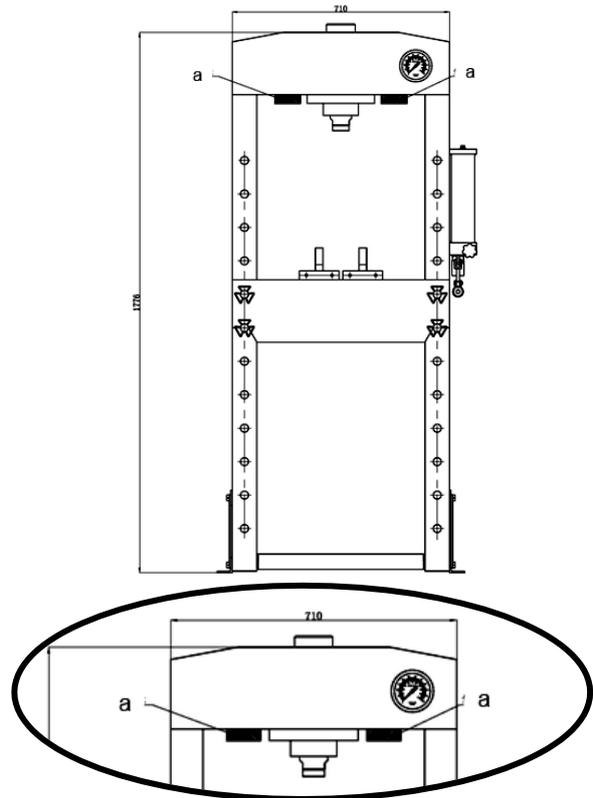
a- Positionnement des fourches du chariot élévateur
