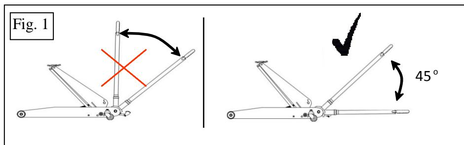
**Bemærk!** Kørestangen placeres i en vinkel på 45 grader og der pumpes nedefter.
