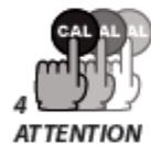
Mettre en mémoire la nouvelle combinaison en appuyant longuement sur la touche cal. Volucompteur Numerique A Turbine K400 passera par le cycle de mise en marche et sera prêt à distribuer dans les unités préétablies
