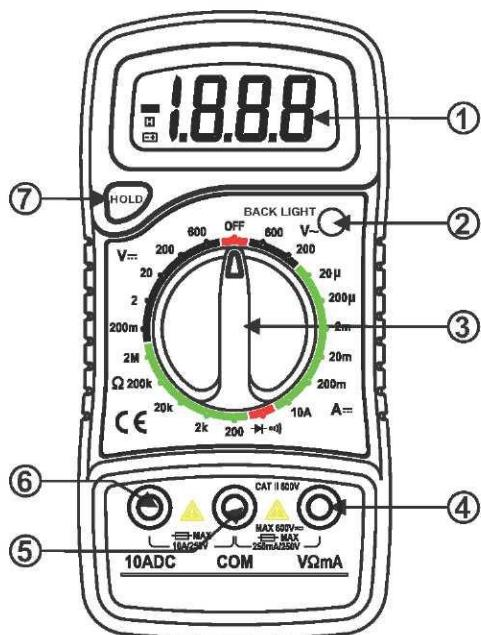
Afin de prolonger la vie de la pile, ce sélecteur doit être positionné sur "OFF" quand l'appareil n'est pas utilisé.
