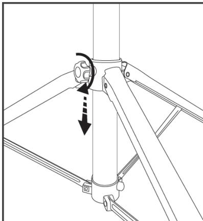
A la hauteur désirée, visser la vis d'ajustement dans le sens des aiguilles d'une montre.
