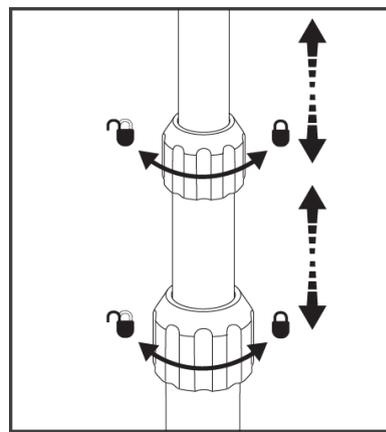
Desserer la vis de compressions en tournant dans le sens inverse des aiguilles d'une montre pour allonger le trépied. Revissez ensuite.
