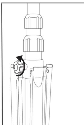
Visser la vis d'ajustement dans les sens inverse des aiguilles d'une montre et ajuster le trépied à la hauteur désirée
