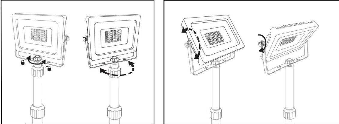
Tournez le bouton du support dans le sens inverse pour le déverrouiller. Le support a une rotation horizontale de 360°, assurez-vous que le câble ne s'emmêle pas avec le support. Tournez le bouton dans le sens des aiguilles d'une montre pour verrouiller l'emplacement souhaité
